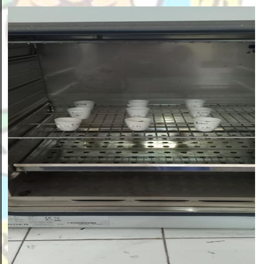
Proses pemanasan ( oven ) sampel okra hijau ( pengujian kadar air ).
